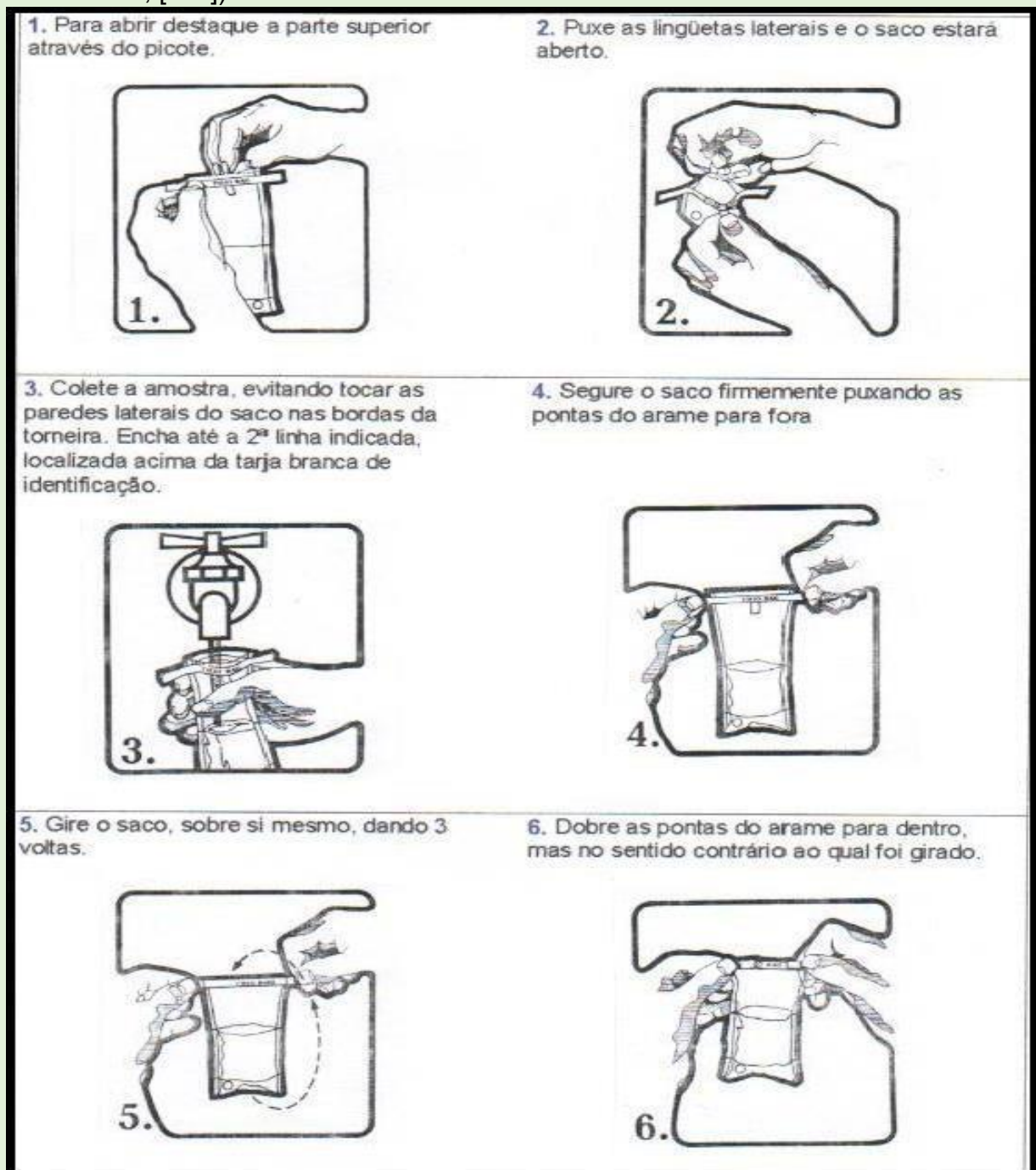
Figura 1 - Coleta de amostra de água utilizando bolsa ou saco estéril (TÜV SÜD/SFDK, [s.d.]).
