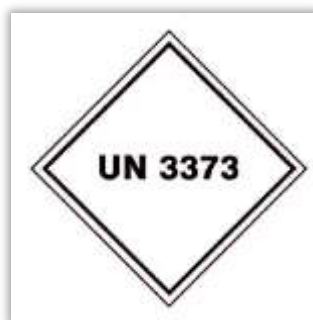
Fig. 6- Marca para identificar embalagens para transporte de substância biológica da categoria B
