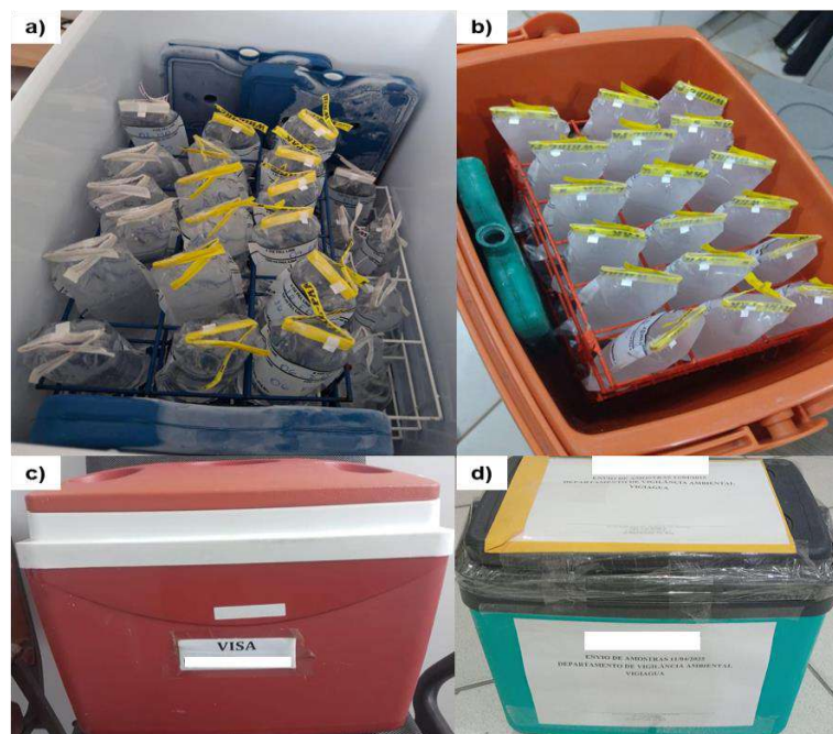
Figura 4. Ilustração do acondicionamento adequado de amostras: recipientes primários (a e b – frasco ou bolsa) inseridos em embalagens isotérmicas (c e d) e mantidos sob temperatura controlada (2 a 8 °C) para transporte ao LACEN/PA.
