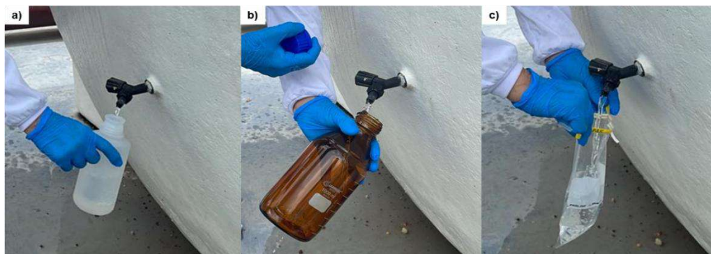
Figura 5. Exemplo de Coleta, frascos (a e b) e bolsa/saco estéril (c).
